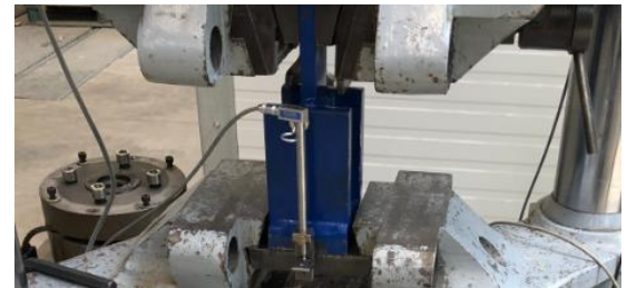
Versuchsstand der zerstörenden Prüfung eines gelenkigen Trägeranschlusses (Trägerhaken), hergestellt mit dem WAAM
